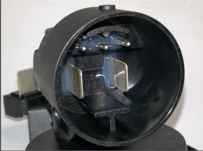
Abdichtung versilberte Kontaktpins (2-stufig umspritzt) in Kunststoffspritzgussgehäuse aus PA6.6 GF35%
