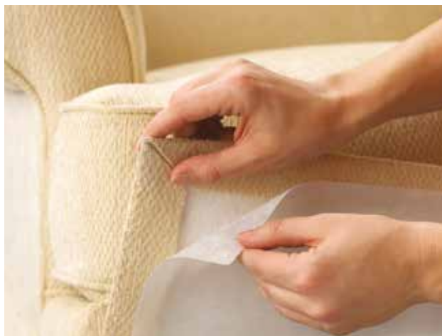
Diese lösemittel- und wasserbasierten Klebstoffe werden oft als "dritte Hand" verwendet, um leichte Materialien an Ort und Stelle zu halten, bis sie genäht oder durch andere Montageverfahren an Ort und Stelle gehalten werden können.
