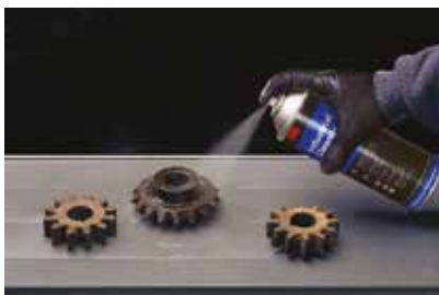
Für die schnelle und einfache Reinigung von Getrieben hilft 3M™ Industriereiniger und Klebstoffentferner, Fett, Öl und Schmutz aufzuweichen und zu lösen. Nach der Einwirkphase kann die von der Oberfläche gelöste Verunreinigung einfach mit einem Handtuch abgewischt werden.
