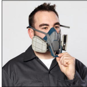
Dichtsitztest mit Unterdruck (3M™ 6035, 6038 / Filter der Serie 2000)
