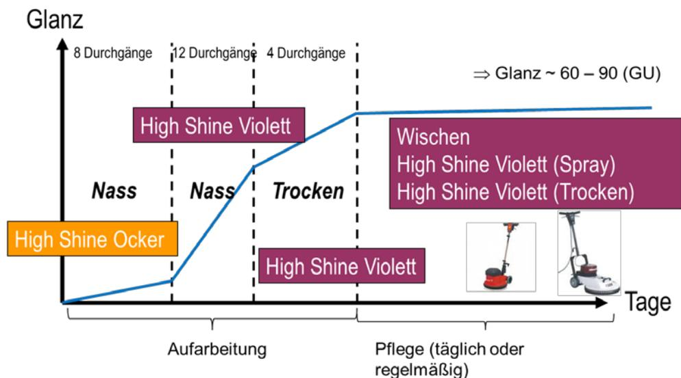
**Beispiel: Anwendung mit Einscheibenmaschine auf Kunststoff- oder Holzböden**
