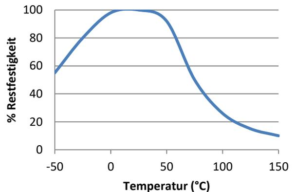
„Hitzebeständige“ Scherfestigkeitsversuche wurden auf Weichstahl durchgeführt. Aushärtung bei Raumtemperatur über 24 Stunden. Vor den Testversuchen wurden die Teile über 30 Minuten auf der Testtemperatur gehalten.
