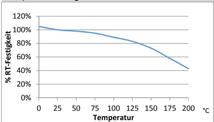
Das Losbrechmoment wurde an M10 Schrauben und Muttern gemessen. Diese wurde nach DIN 54454 ohne Vorspannung verklebt.
