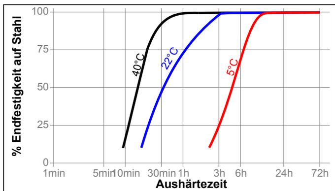
**Aushärtegeschwindigkeit in Abhängigkeit vom Aktivator**
