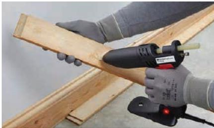
Geeignet für viele Holzbearbeitungs-Anwendungen, mit gutem Durchsatz und gleichmäßigem Auftrag.
