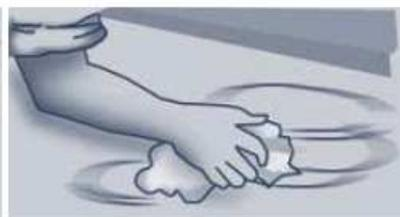
6. In Nasszonen empfehlen wir, die Kanten des 3M Safety-Walk Nasszonenbelags mit dem 3M Safety-Walk Kantenschutz zu versiegeln, um ein Eindringen von Feuchtigkeit auszuschließen. Achten Sie darauf, dass der Kantenschutz sowohl das Antirutschmaterial als auch den Untergrund abdeckt. Nach der Trocknung des Kantenschutzes (etwa 30 Minuten) kann die Fläche wieder betreten werden.
