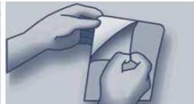
3. Enden eines Safety-Walk Stückes umbiegen. Schutzliner teilweise abziehen und 3M Safety-Walk passend verlegen. Den Kleber nicht berühren. Auf Treppen 3M Safety-Walk im Abstand von 12-15 mm von der Vorderkante der Stufe verlegen, um ein Beschädigen der Ränder zu vermeiden.
