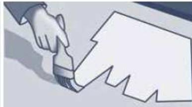
2. Auf porösen oder rauen Oberflächen (wie unbehandeltem Holz, Beton oder Naturstein) zuvor 3M Grundierung (z. B. 3M Scotch-Weld Tape-Primer 83 oder 3M Primer 94) mit einem Pinsel an exakt der Stelle auftragen, auf der Safety-Walk verlegt werden soll. Grundierung antrocknen lassen.
