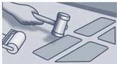
5. Benutzen Sie den Handandruckroller, um eine feste Verbindung und gute Anfangshaftung zu erzielen. Für die Verlegung von 3M Safety-Walk Verformbar sollten Sie zum Andrücken auch einen Gummihammer verwenden, um das Material der strukturierten Oberfläche anzupassen.
