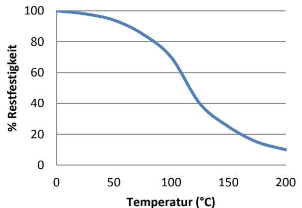
„Hitzebeständige“ Scherfestigkeitsversuche wurden auf Glas auf Weichstahl Klebeverbindungen durchgeführt. Vor den Testversuchen wurden die Teile über 30 Minuten auf der Testtemperatur gehalten. UV683 kann bei geringen Belastungen kurzzeitig auch höheren Temperaturen ausgesetzt werden (z.B. bei Einbrennlack- oder Schwall-Löt-Verfahren). Niedrigste Temperatur bei Endfestigkeit: -55°C (abhängig von den verwendeten Materialien).
