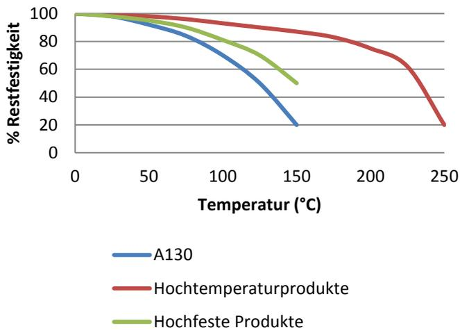
*"Hitzebeständige" Losbrechfestigkeit wurde bei verzinkten Schrauben M10 gemäß ISO 10964 geprüft. Aushärtung bei 23°C über 24 Stunden. Vor den Testversuchen wurden die Teile über 30 Minuten auf der Testtemperatur gehalten.*
