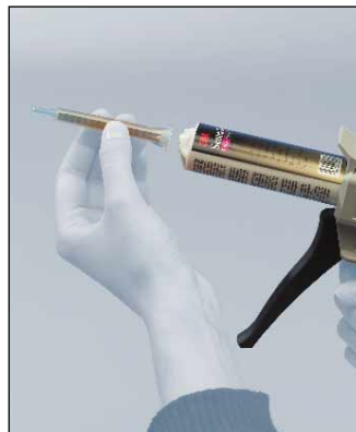
Verschlusskappe entfernen - das freie Fließen beider Komponenten durch Probeauftrag prüfen - Mischdüse aufsetzen und durch Linksdrehung fixieren
