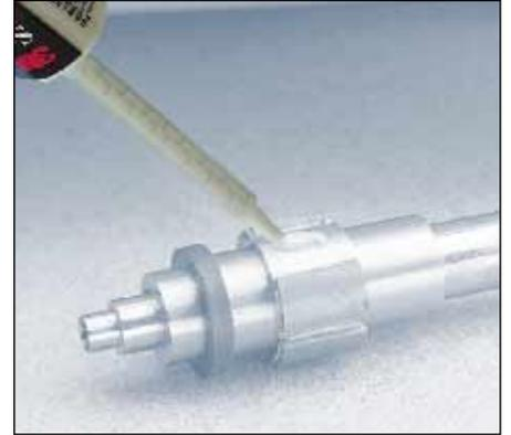
Kleben eines Magneten an einen Stahlrotor
