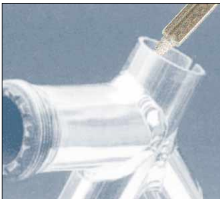
Kleben von Rohrverbindungen 3M Scotch-Weld DP 490
