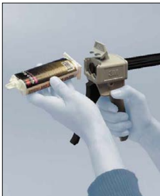
Kartusche in das Auftragsgerät einsetzen und mit dem Verschluss arretieren
