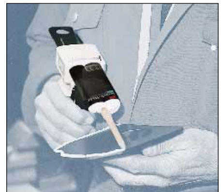
Kleben von PU Teilen an ein Armaturenbrett aus PP 3M Scotch-Weld DP 8005
