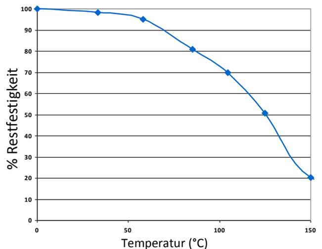
ET5389 kann bei geringen Belastungen kurzzeitig auch höheren Temperaturen ausgesetzt werden (z.B. bei Einbrennlack- oder Schwall-Löt-Verfahren). Niedrigste Temperatur bei Endfestigkeit: -40°C (abhängig von den verwendeten Materialien).
